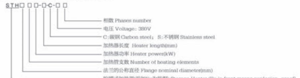
例如：STH3603-15-2.5C-3803为法兰通径360mm，三支总功率15kW，加热器总长2.5米，材质为碳钢，工作电压380V3相。
