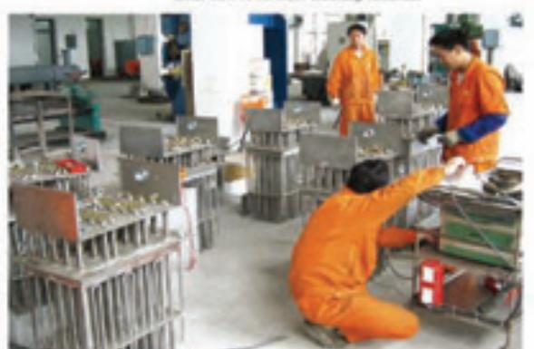
● 通道式电加热器电气测试
