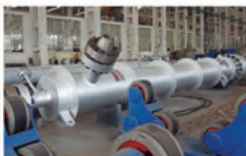
● 合成氨高压电加热器
