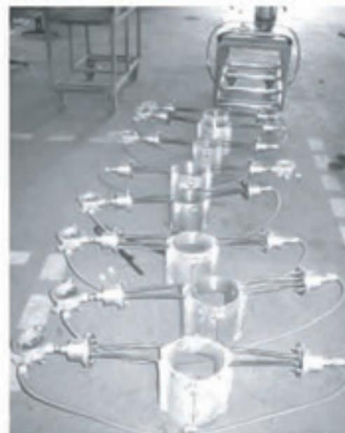
小直径整体铸铜电加热器
