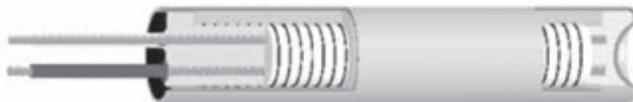
高密度电热元件示意图 High Wattage Density Cartridge Heater Diagram
